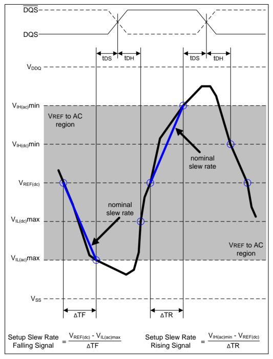
Figure 24 – Illustration of nominal slew rate for tDS (differential DQS, DQS)
