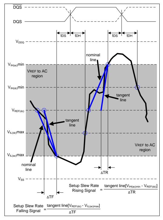
Figure 25 – Illustration of tangent line for tDS (differential DQS, DQS)
