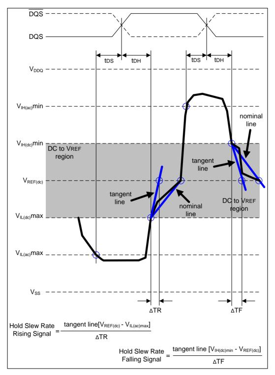
Figure 27 – Illustration tangent line for tDH (differential DQS, DQS)
