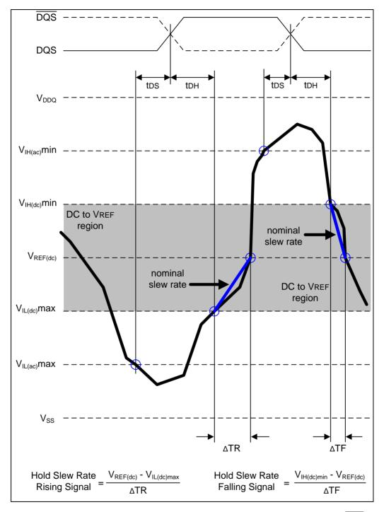
Figure 26 - Illustration of nominal slew rate for tDH (differential DQS, DQS)
